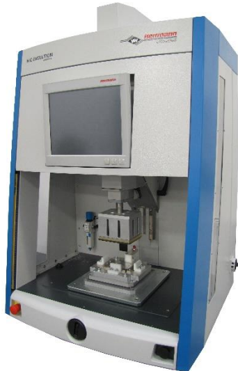
HERRMANN ULTRASCHALL HiQ Evolution Speed Control ultrahanghegesztőgép és ROTHENBERGER ROWELD P160B hőtükrös csőhegesztő gép
