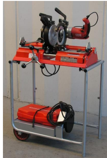
HERRMANN ULTRASCHALL HiQ Evolution Speed Control ultrahanghegesztőgép és ROTHENBERGER ROWELD P160B hőtükrös csőhegesztő gép
